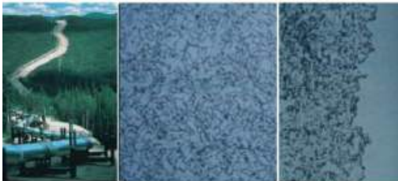
ラインパイプ サブマージ溶接金属 微細粒均一組織と低温でのシャルピー衝撃試験片破壊伝播経路写真 溶接直後（録込み直後）で オーステナイト粒界も見えない均一な微細粒フェライト組織 これほど均一な微細フェライト組織が 溶接直後で作れるなど予想されなかった時代である
