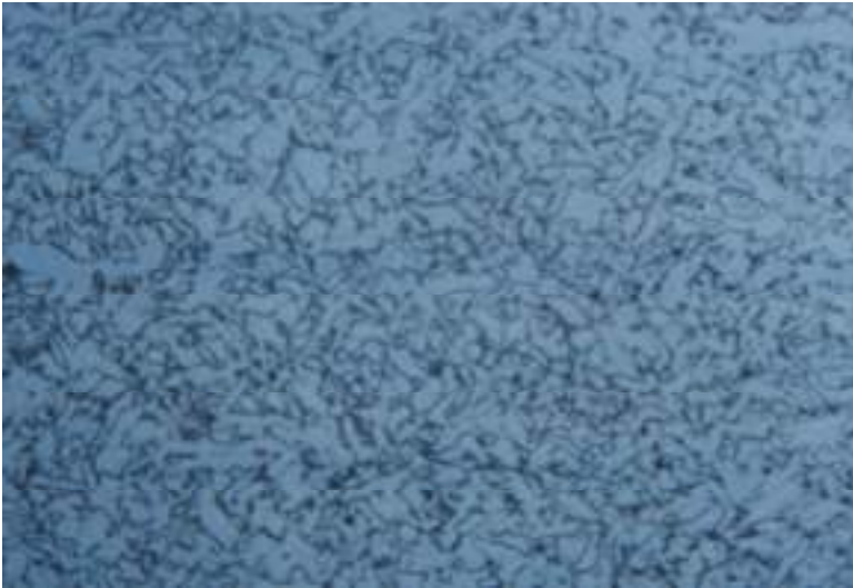
ラインパイプ サブマージ溶接金属 微細粒均一組織と低温でのシャルピー衝撃試験片破壊伝播経路写真 溶接まま〔鑄込みまま〕で オーステナイト粒界も見えない均一な微細粒フェライト組織 これほど均一な微粒フェライト組織が 溶接ままで作れるなど予想されなかった時代である
