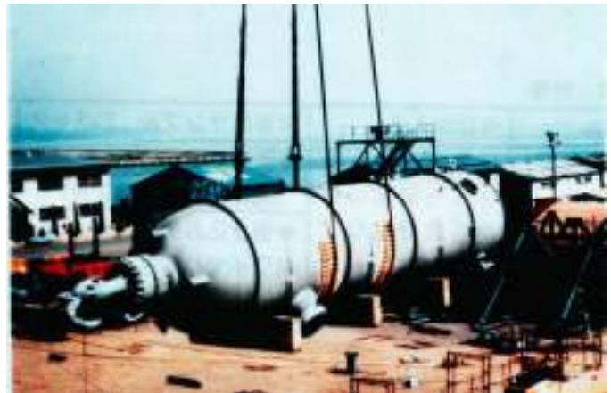
住重東予と共同開発した 31/2Ni 鋼極厚低温用リアクターの大入熱共金溶接
